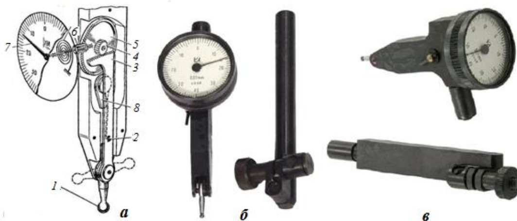
Рис. 50. Измерительные головки бокового действия
