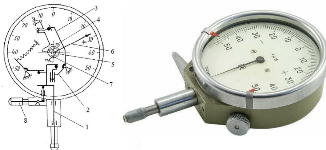
Рис. 46. Схема и внешний вид рычажно-зубчатой головки 1ИГ
