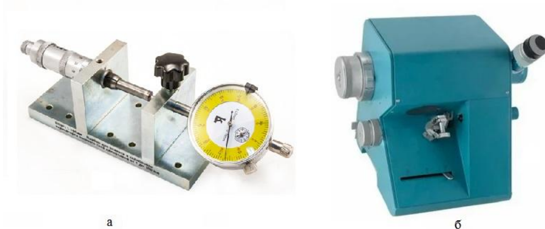
Рис. 45. Средства поверки индикаторов часового типа (а – микрометрическое приспособление; прибор ППИ-4)
