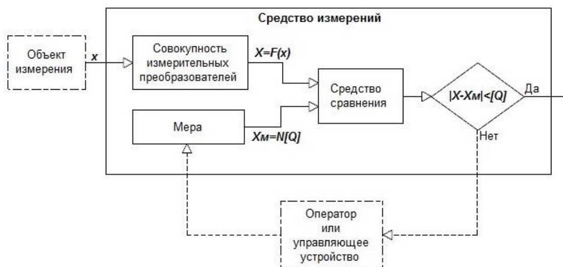
Рис.13. Обобщенная структурная схема средства измерений
