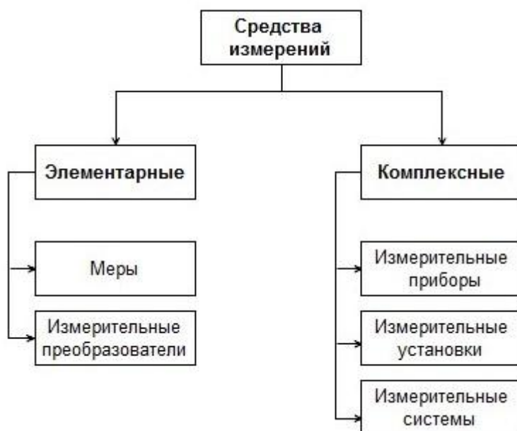
Рисунок 14 – Классификация средств измерений по выполняемым функциям
