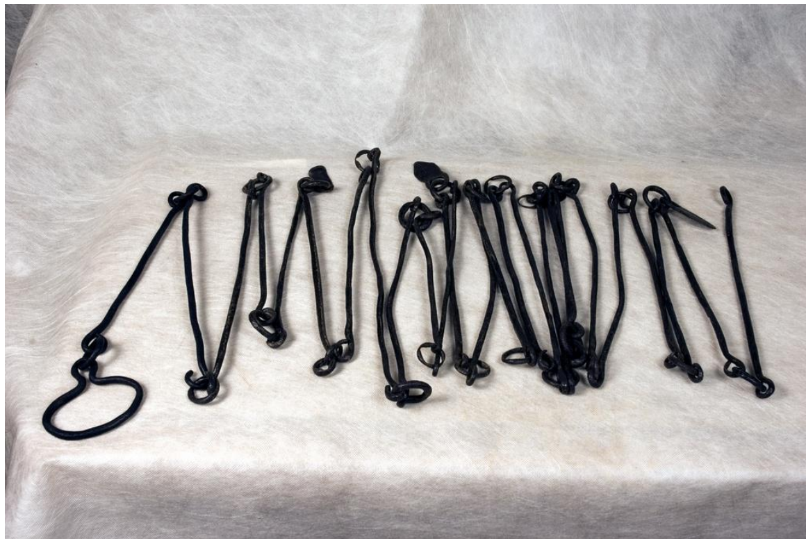
Рис. 2. Землемерная цепь (Россия, 1800 – 1860 гг.)
