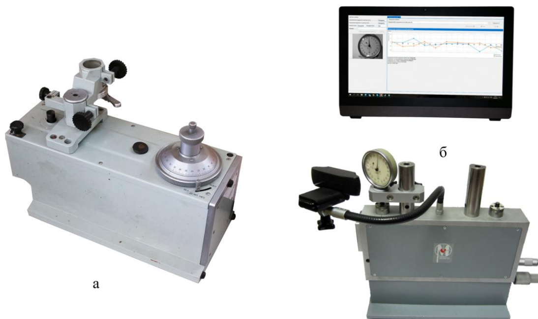
Рис. 47. Приборы для поверки измерительных головок (а – ППГ-2А; б – ППГ-4)
