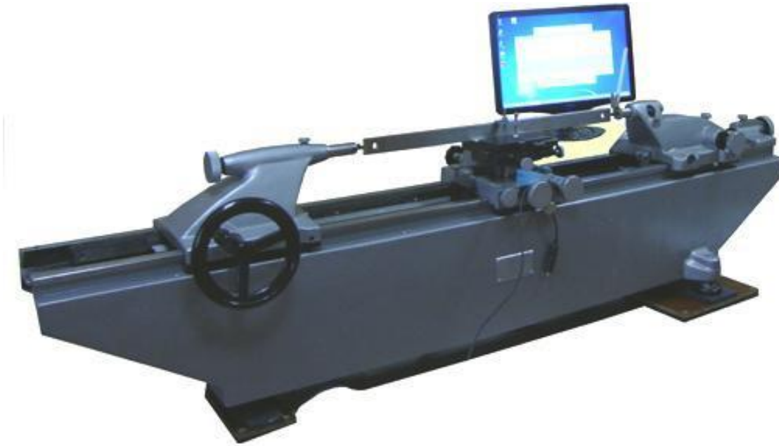
Рис. 58. Электронная измерительная машина ИЗМ–10э
