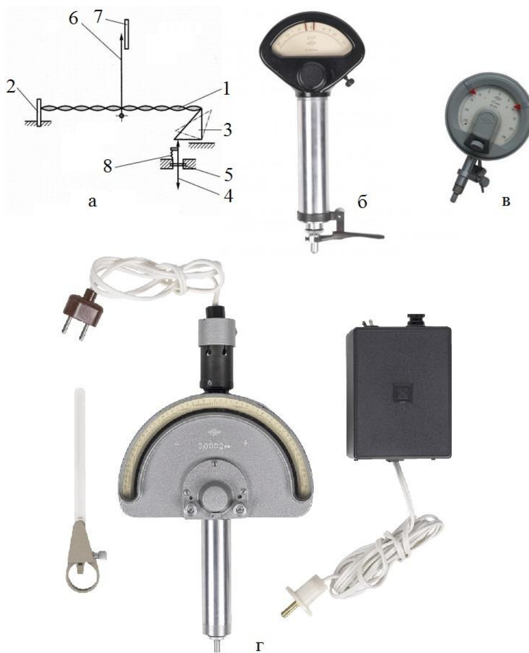
Рис. 49. Схема и внешний вид пружинных измерительных головок (а – схема; б – микрокатор; в – микатор; г – оптикатор)
