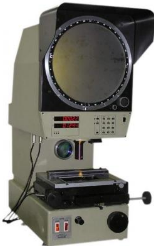
Рис. 67. Измерительный проектор ПИ-300ЦВ
